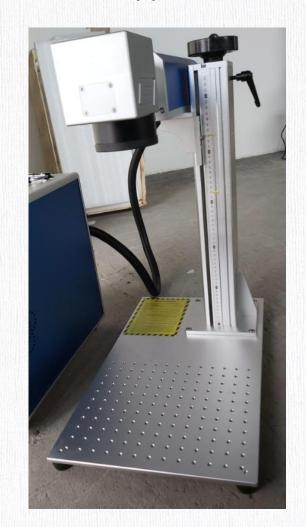
工作平台 Working platform 开机时,打开电源,按顺序打开激光发生器、振镜电源和红光定位,然后打开场镜盖子。
