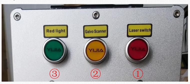
要关闭电源时,盖上场镜盖子, 按顺序关闭激光发生器、振镜电源、红光定位,然后关闭电源。
